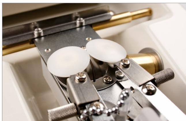
Les deux guidages pour le verre possèdent chacun des roulettes en plastique réglables de façon précise permettant ainsi un positionnement précis au-dessus de la meule de rainurage
